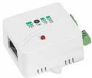
Cuerda de detección de inundaciones con salida de relé y puerto para conexión a puertos de sensores.
