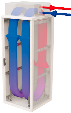
Recorrido del aire a través del rack: CoolSpot versión CW TW
