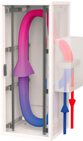
Recorrido del aire a través del rack: CoolSpot versión CW WW
