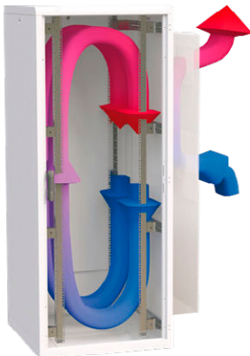
Recorrido del aire a través del rack: CoolSpot versión DX WM
